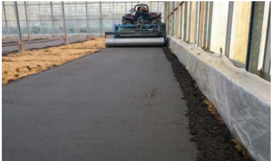
De nieuwe spitmachine met hydraulisch aangedreven gladde rol. Het aandrukken zorgt er voor dat het biologische middel in de toplaag ook goed zwelt en dat de grond vochtig blijft.
